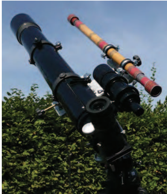
Abbildung 4.6: 102 mm Fraunhofer-Refraktor des Autors, parallel dazu montiert der Astromedia-Nachbau eines der beiden Galilei-Fernrohre (Objektiv-Brennweite: +780 mm, Okularbrennweite: -65 mm, 12-fache Vergrößerung, original-typisch kleines Gesichtsfeld mit Tunnelblick) Foto: H.-G. Pellengahr
