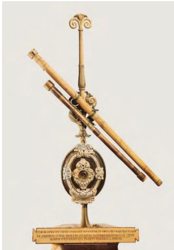
Abbildung 4.3: Von Galilei gebaute Fernrohre (90 bzw. 130 cm lang) Istituto e Museo di Storia della Scienza Firenze
