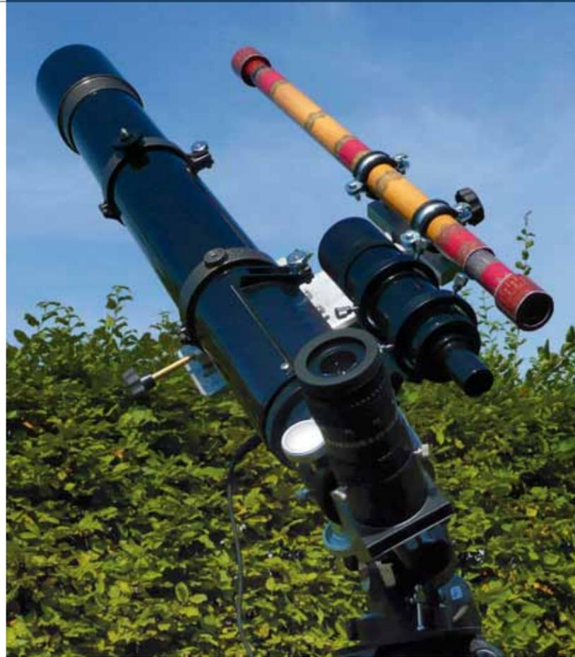
**3** Nachbau eines Galilei Fernrohrs und moderner 4 Zoll-Refraktor, Foto des Autors. Astromedia-Bausatz: Glaslinsen und gestanzter Karton in Leder- u. Golddesign-Nachbildung gem. historischem Vorbild; der einfache Zusammenbau erfordert etwa einen Tag; mittels kleiner Baumarkt-Rohrschellen auf einem Stativ montiert, liefert der historische Nachbau einen recht authentischen Eindruck von der optischen Leistung der ersten Perspicilla.
