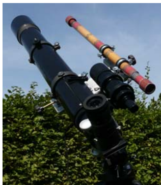
Nachbau eines Galilei-Fernrohrs u. moderner 4-Zoll-Refraktor
